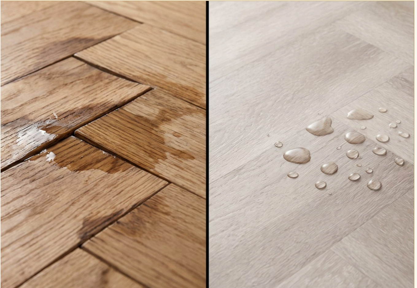
باركيه خشبي متقوس ومنفوخ بعد تسرب مقابل ماء يتحبب فوق SPC بالتصليق – مقاوم للماء 100%
