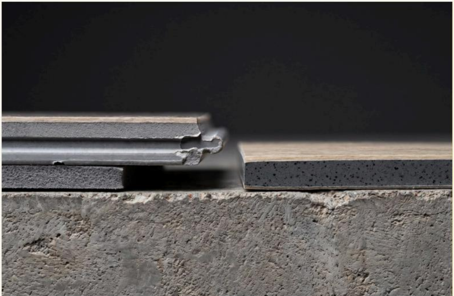
Coupe technique : sol clipsable flottant (vide d'air, clip fragile) vs SPC à Coller 2,5 mm collé en plein
